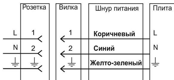
Схема подключения плиты к трехфазной электрической сети переменного тока напряжением 380 В
